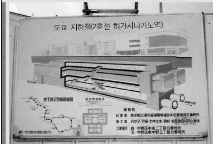
도쿄의 지하철 12호선(大江戸線) 히가시시나가노 역(가칭) 완성 예상도 -지하철 공사 현장의 안내판
