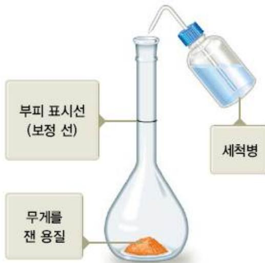
**a** 용량 플라스크(volumetric flask)에 무게를 측정된 물질(용질)을 넣고, 소량의 물을 가한다.
