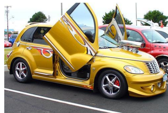
튜닝으로 만든 시저도어 안전장치가 없어 위험함 [보통의 시저, 결빙도어는 사고, 전복시 문을 열 수 없을 때 문이 힌지에서 아예 빠져버리 게 만드는 비상안전장치가 있음]
