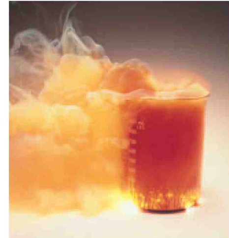
알루미늄과 브롬 간의 산화환원 반응은 열을 방출하고 액체 브롬이 끓으면서 기화된 브롬 증기를 생성한다.
