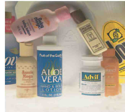
그림 7.4 몇몇 병들은 HDPE로 만들어졌으며 가장 흔히 재활용되는 고분자 재료 중 한 가지이다.
