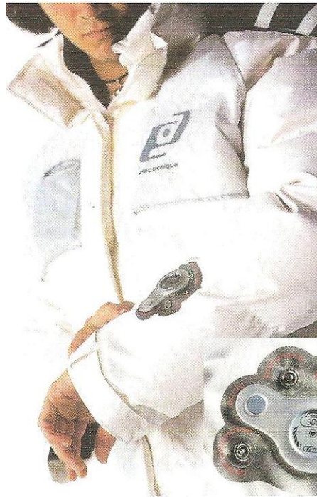
위성항법장치를 갖춘 스키복-위치,거리,체온,기온 측정
